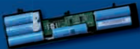
▲ Una batteria Dell "nuda", con sei celle e un dispositivo elettronico di controllo.
